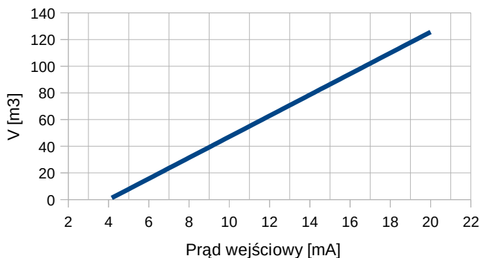
Rys. 10.6 Charakterystyka objętości zbiornika w zależności od prądu wejściowego z sondy poziomu cieczy w zbiorniku (dla zakresu 4÷20mA).
